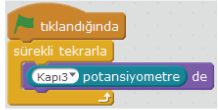
Resim 6.72: Potansiyometre kullanım örneği
