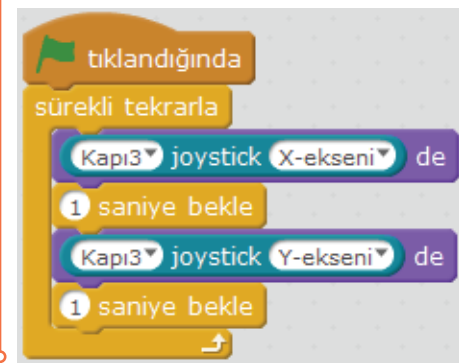
Resim 6.84: Joystick kullanım örneği
