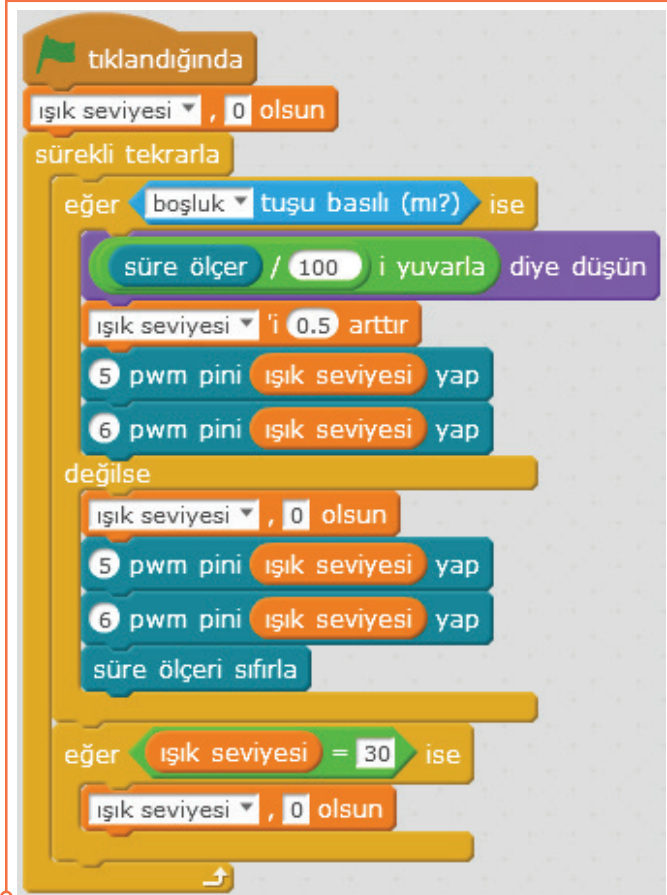
Resim 6.52: Arduino UNO ile PWM uygulaması
