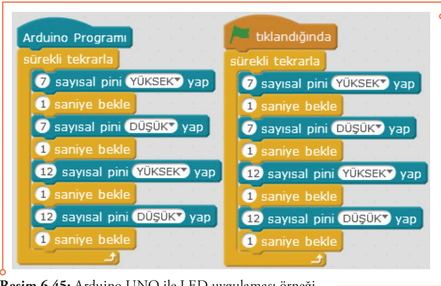
Resim 6.45: Arduino UNO ile LED uygulaması örneği
