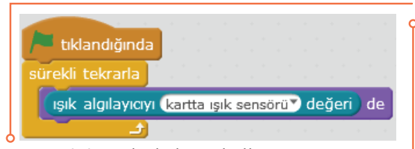
Resim 6.62: Işık algılayıcı kullanım örneği
