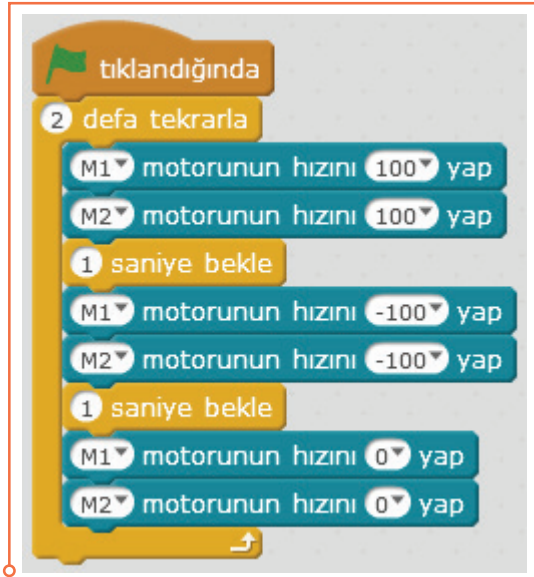
Resim 6.55: mBot Robotun hareketi için DC motor kullanım örneği
