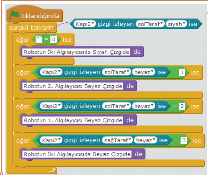
Resim 6.69: Robotun çizgi algılayıcıları ile çizginin neresinde olduğunu belirleyen uygulama örneği
