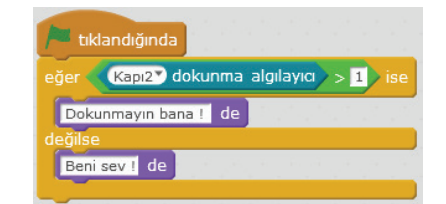
Resim 6.75: Dokunma algılayıcı kullanım örneği
