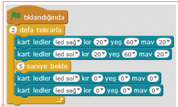
Resim 6.56: mBot Robot üzerindeki RGB LED kullanım örneği
