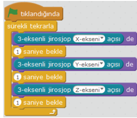
Resim 6.83: Jiroskop algılayıcı kullanım örneği
