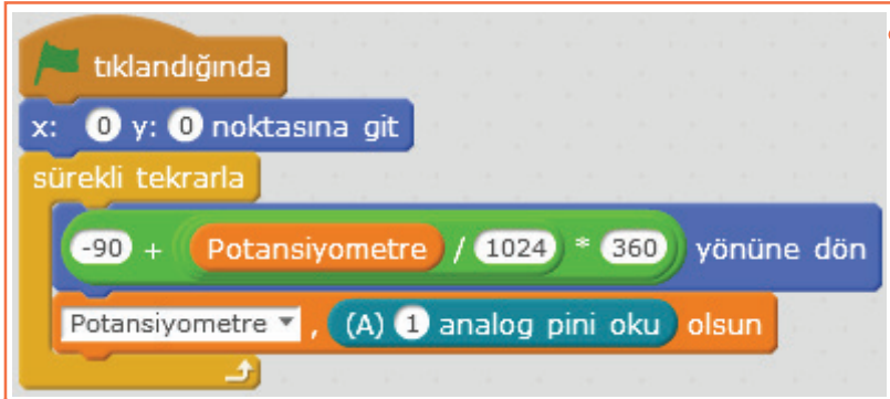
Resim 6.49: Arduino UNO ile Potansiyometre uygulaması örneği
