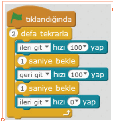
Resim 6.54: Robot hareketi için DC motor kullanımı örneği
