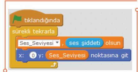
Resim 6.65: Ses seviyesine göre ekrandaki kuklayı zıplatan uygulama
